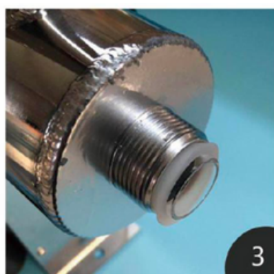
Lắp ống bọc có vòng cao su chống thấm dạng côn vào buồng phản ứng
