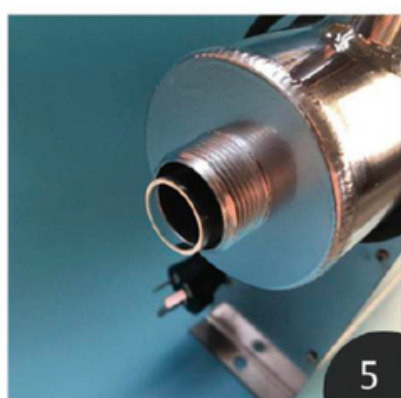
Lắp vòng cao su chống thấm hình côn vào vỏ cách lỗ 10 mm và ấn chặt.
